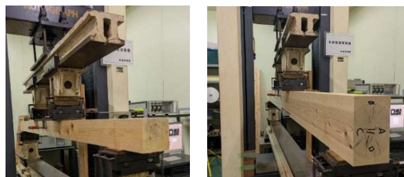
図 1 曲げ強度試験（左：ヒノキ、右：スギ）
