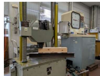
図 2 めり込み試験 (材端部加圧)
