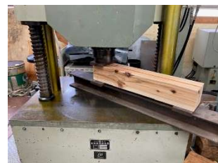
図2 めり込み試験 (材端部加圧)
