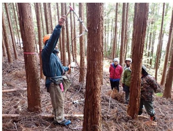
図1 スギ精英樹交雑育種検定林第2～4号地での応力波伝播速度測定の様子
