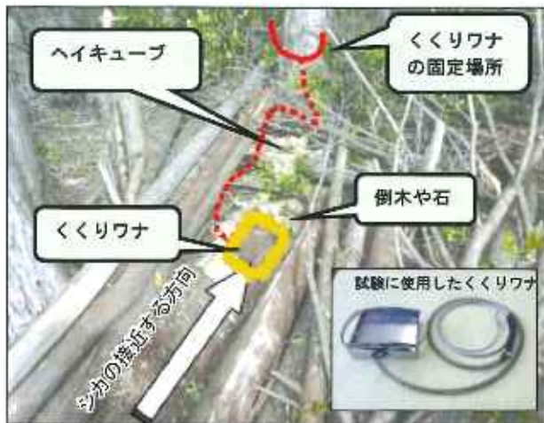
図6 機材の設置例
