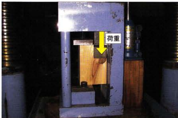
図2 いす型方式によるせん断試験
