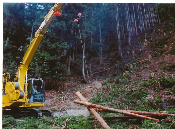
写真1 スイングヤードによる集材作業
