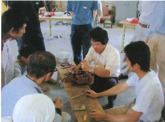
(チェーンソー本体の分解点検中) 器具機械整備 (チェーンソー整備) (5/20～5/22)
