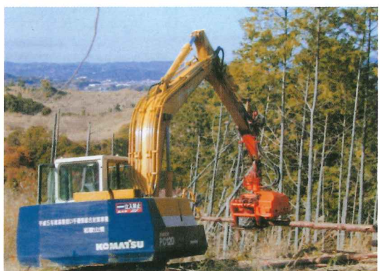
(プロセッサにて造材作業中) 高性能林業機械オペレーター (12/2～11)
