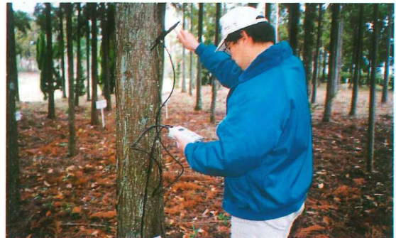
写真2 同測定機を利用した立木強度測定
