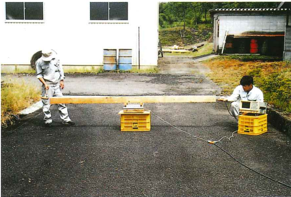
写真1 ヤング係数の測定(非破壊での測定が可能)
