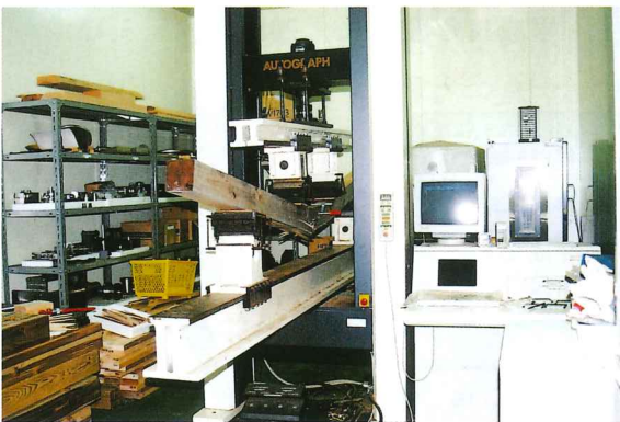
写真2 曲げ破壊強度の測定
