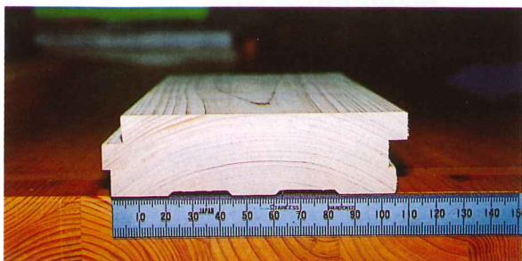
写真-2 床材の本実加工
