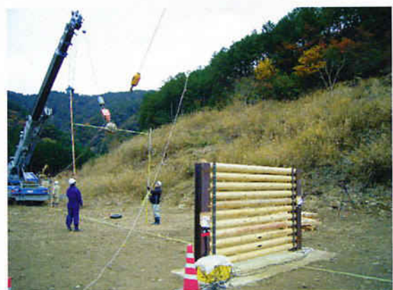
写真6 振り子形式による重錘衝突試験
