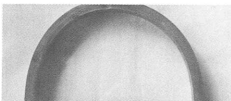
写真1 スギ間伐材を用いた曲げ加工
