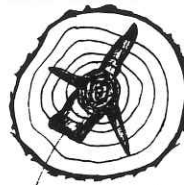
他の原因による変色 ニホンキバチによる スギの変色
