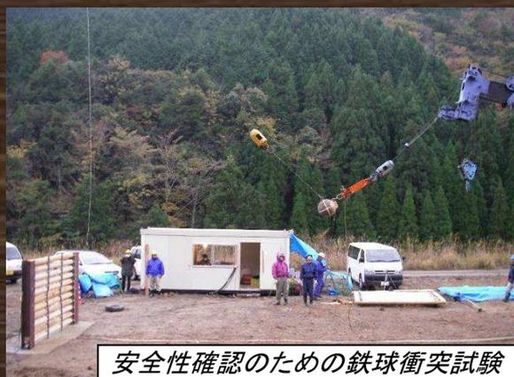
安全性確認のための鉄球衝突試験
