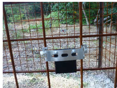
図 6 新型トリガー装置のセンサー部
