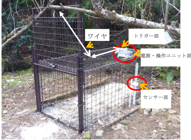
図1 電子トリガーの設置状況と仕様 (試作最終型)
