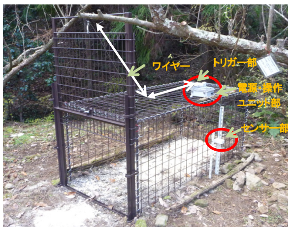
図 1 電子トリガーの設置状況と仕様
