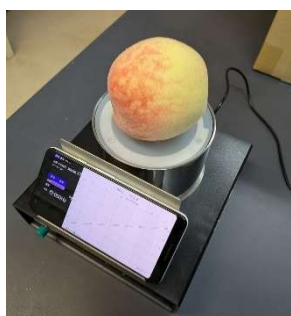
写真 2 「果振台」による測定
