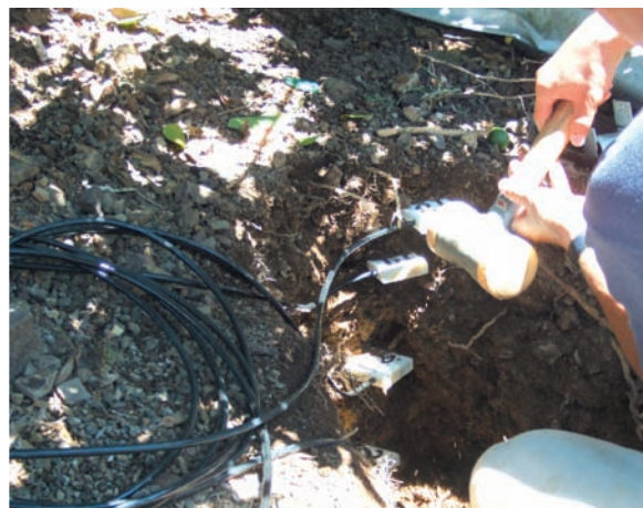
写真3 TDR土壌水分計により深さ別の土壌水分の変動を計測
