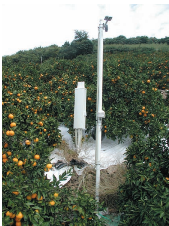
写真2 フィールドサーバーによる気象データの計測
