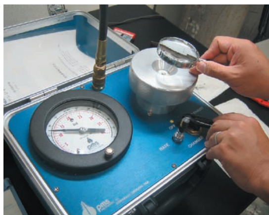
写真1 プレッシャーチャンバーによるLWP測定
