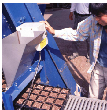
写真1 施肥機を利用した表面施肥状況
