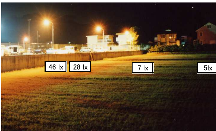
図3 駐車場照明からの距離と照度(例)
