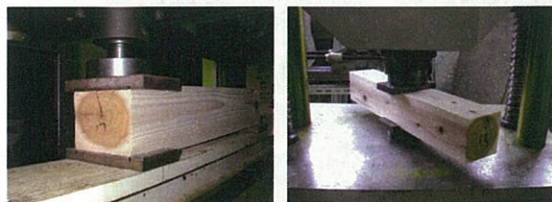
図2 部分圧縮(めり込み)試験 (左:材端部加圧、右:材中央部加圧)
