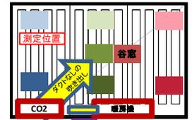
局所加温用ダクトと循環扇を併用することでCO<sub>2</sub>を施設内にムラなく拡散
