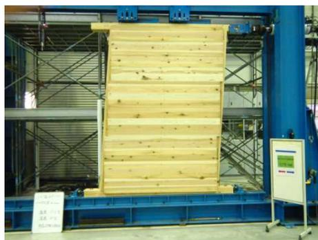
写真 面内せん断試験の実施状況
