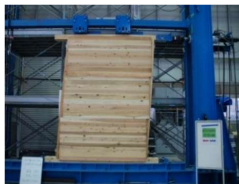
面内せん断試験の様子
