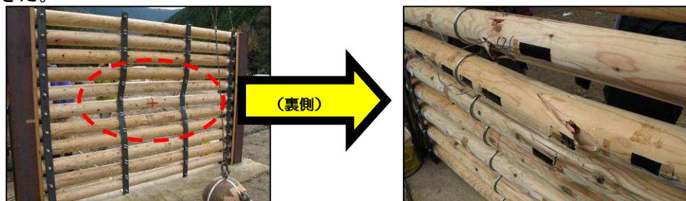
図 6 実証試験における損傷の様子（鉄球振り上げ高さ 2.73m）
