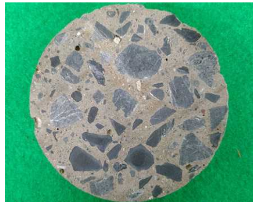
リグニンを添加したコンクリート (大林組製リグニコンクリート)
