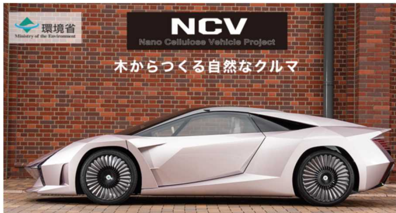
セルロースナノファイバーを利用したコンセプトカー (22の大学、企業等が連携して製作)
