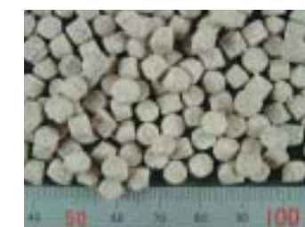
図1 廃砂・ガラス焼結発泡材料の試作品
