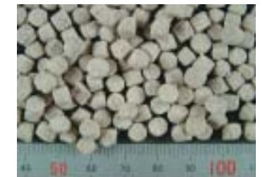
图1 廃砂・ガラス焼結発泡材料の試作品 图1 废砂、玻璃烧结发泡材料的试制品
