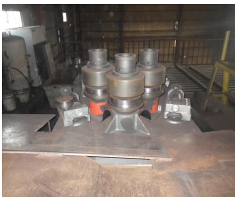
最新鋭のフランジ加工装置
