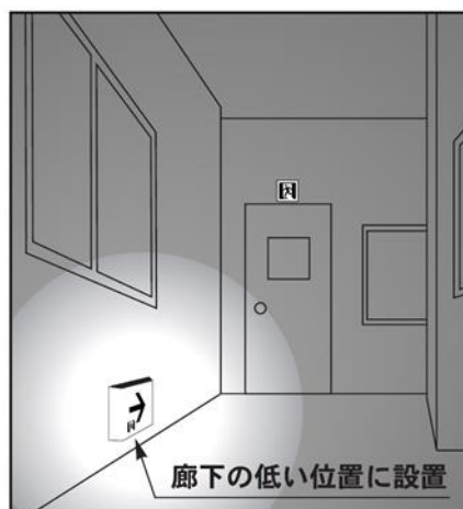
低姿勢になっても避難する方向がわかるよう誘導灯を低い位置に設置した例
