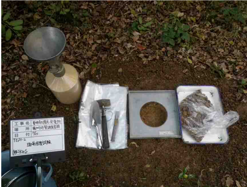
現場密度試験
