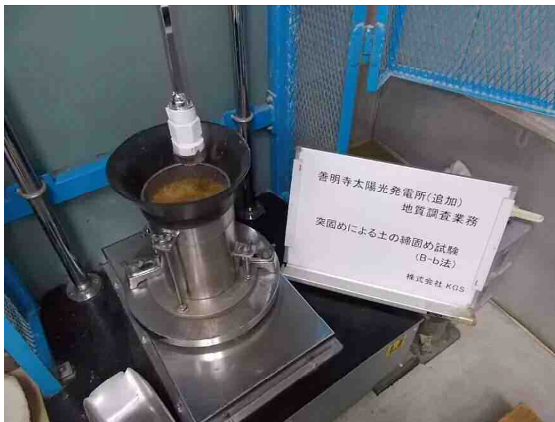
突固めによる土の締固め試験 (B-b 法)
