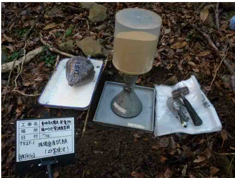
現場密度試験(砂置換法)
