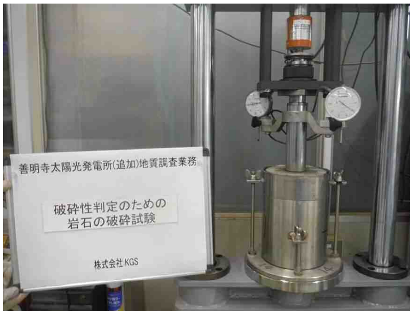
破碎性判定のための 岩石の破碎試験
