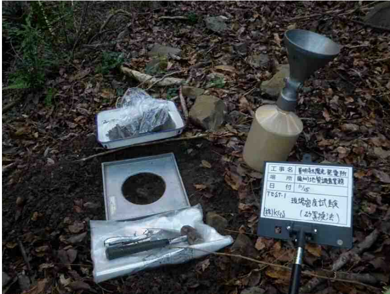
現場密度試験(砂置換法)
