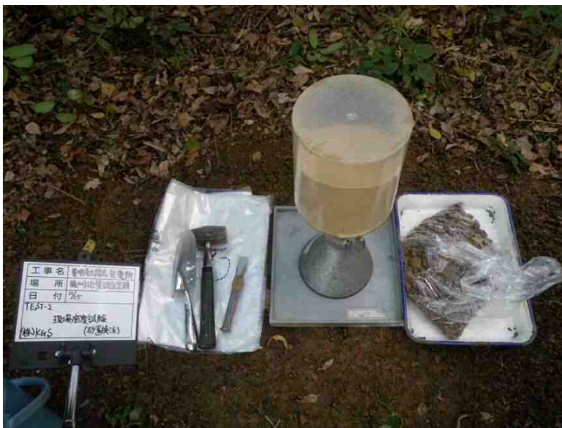
現場密度試験(砂置換法)
