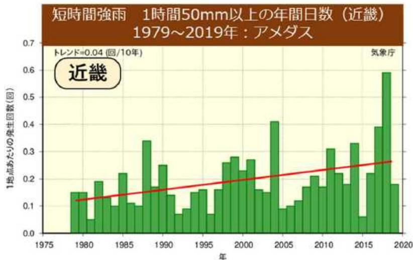
図 3-1-3 近畿地方のアメダス 1 地点当たりの短時間強雨（1 時間降雨量 50 mm 以上）の発生回数の変化（出典：気象庁資料）
