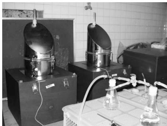
小型堆肥化実験装置による梅調味廃液を用いた鶏ふん堆肥化試験
