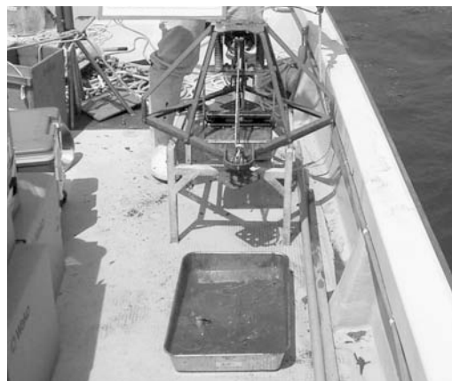
ダイオキシン類底質採取 (採泥機)
