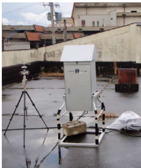
ダイオキシン類大気採取の様子 (ハイボリウムエアサンプラー)
