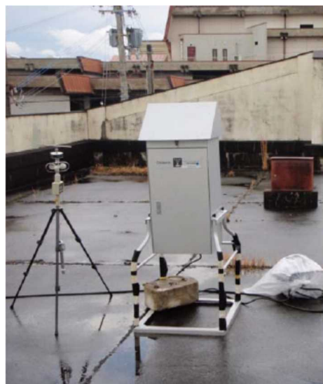
ダイオキシン類大気採取の様子 (ハイボリュームエアサンプラー)
