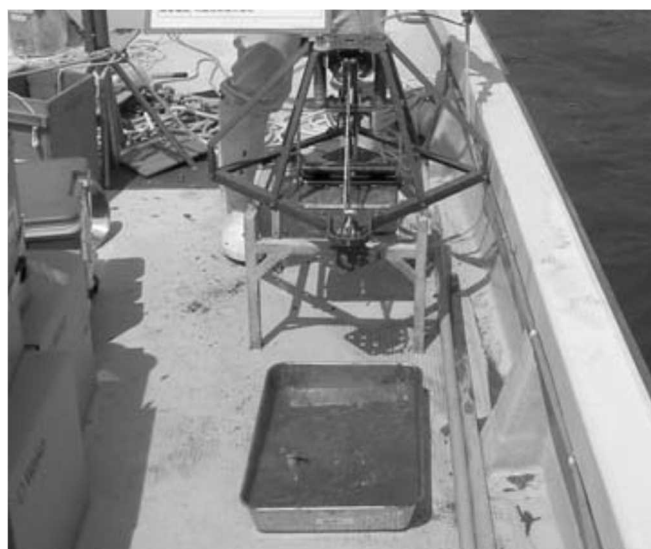
ダイオキシン類底質採取の様子 (採泥機)
