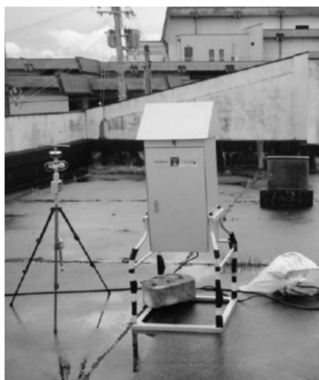
ダイオキシン類大気採取の様子 (ハイボリウムエアサンプラー)
