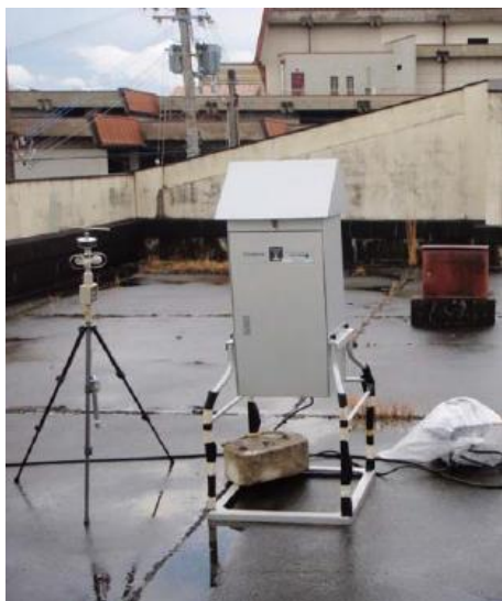
ダイオキシン類大気採取 (ハイボリウムエアサンプラー)
