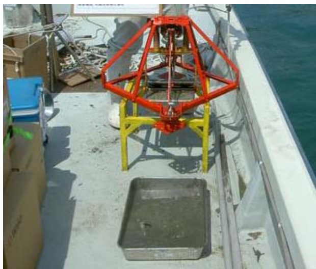
ダイオキシン類底質採取（採泥機）
