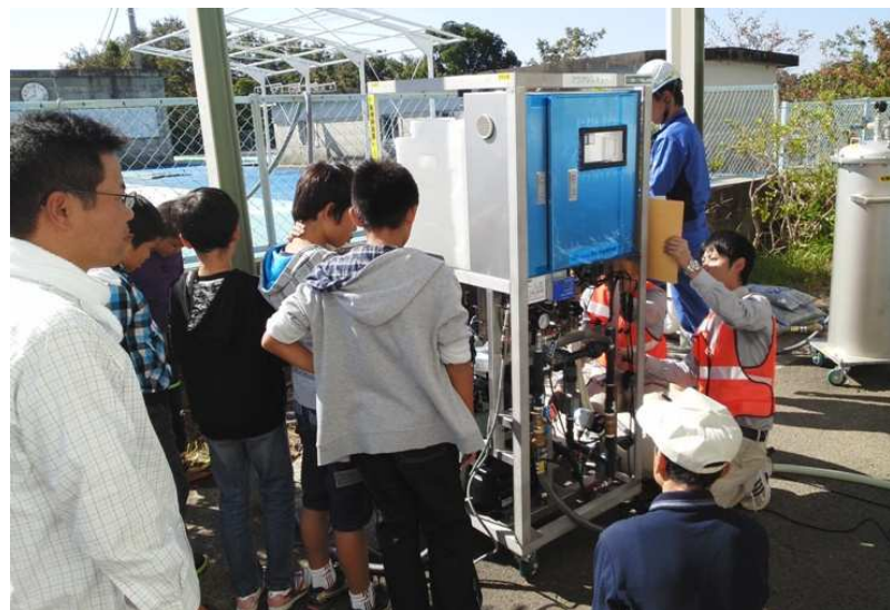
田辺市新庄第二小学校(プール水から飲料水を造水)
