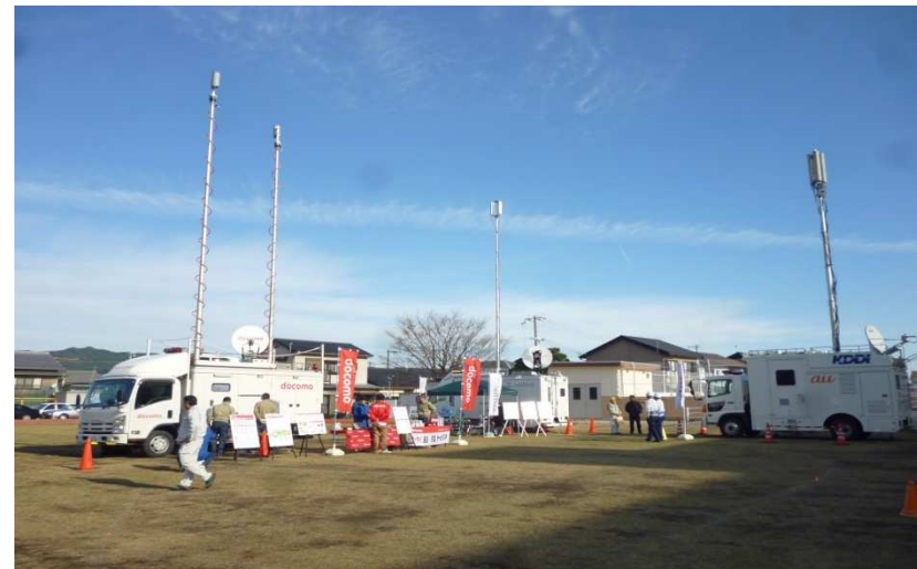
携帯事業3社の移動基地局車の状況
