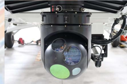
災害発生時に上空から現場の状況を撮影し、映像をリアルタイムに配信する。赤外線カメラに切り替え可能で、火災での熱源確認や捜索活動にも使用する。
