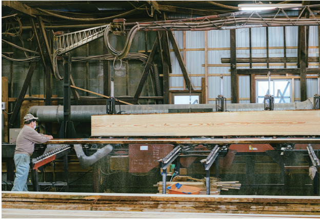
大型機械を使い、一本の木から製材していく。
