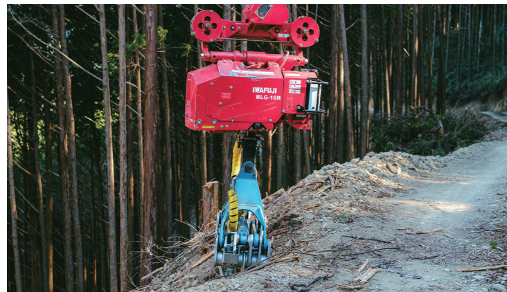
①「新たな架線集材システム」は油圧集材機と架線式グラップルをシステムラジコンで無線操作する。②AIを使用したシステムの開発も、架線を張る作業から始まった。
