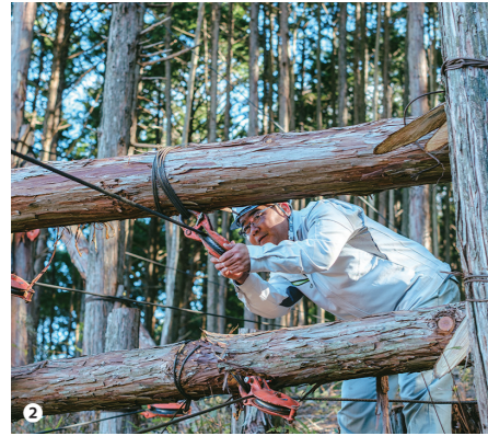
①「新たな架線集材システム」は油圧集材機と架線式グラップルをシステムラジコンで無線操作する。②AIを使用したシステムの開発も、架線を張る作業から始まった。
