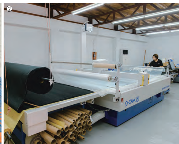
②岡田さんが代表取締役を務める株式会社岡田織物で導入された自動裁断機。他企業の製品も裁断を請け負い、産地全体の業務効率化に繋がっている。
