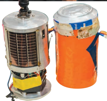
トレーニング用に作られる「CanSat」。様々な機能を詰め込み、地上4000メートルの高さから落下実験を行う。
