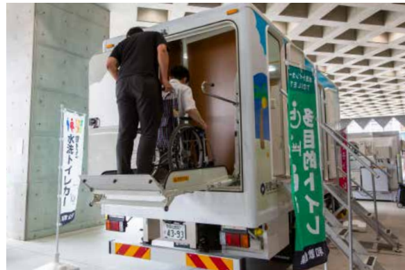
トイレカー 停電・断水時でも衛生的な水洗トイレを使用可能
