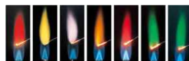
リチウム (赤) ナトリウム (黄) カリウム (赤紫) カルシウム (橙赤) ストロンチウム (赤) バリウム (黄緑) 銅 (青緑)
