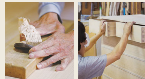
木目の細かい木肌は、箆笥の印象を決める扉に使用。加工はすべて職人の手仕事。経験と勘が桐材の美しさを最大限に引き出します。 紀州箆笥の特徴は、美しいだけでなく高い気密性。引き出しをそっと押すと、隣の引き出しがすっと前に。空気力で動きます。
