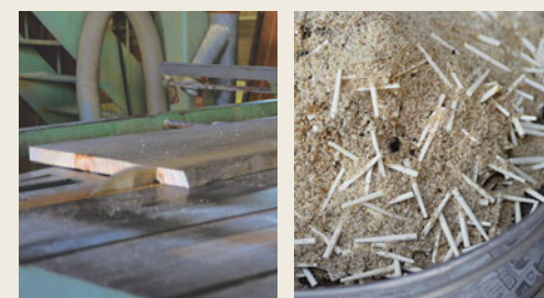
桐の性質を知り、造材した木材を無駄なく箆笥に生かすための重要な木取り。木肌を見極め、扉や引き戸など適材適所に無駄なく切断。 木釘作りは職人の重要な仕事。ぬかと一緒に木釘を熱し、内部の水分を飛ばしてぬかが持つ油脂を表面にまとわせる。
