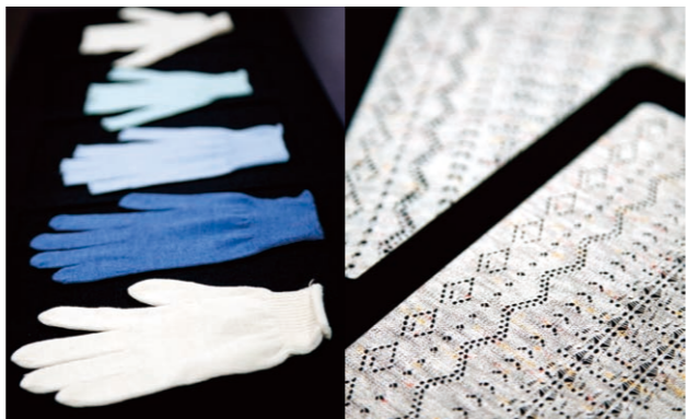
左/最初に作った無縫製の手袋がホールガーマントに進化した。右/見るだけではどちらが本物か分からないほどの優れた再現能力のおかげで、見本生地を作る必要がなくなり、製品化はスピードアップしコストが下がり、さらにはエコにもつながる。(手前が出力したもの。奥が実際の生地)
