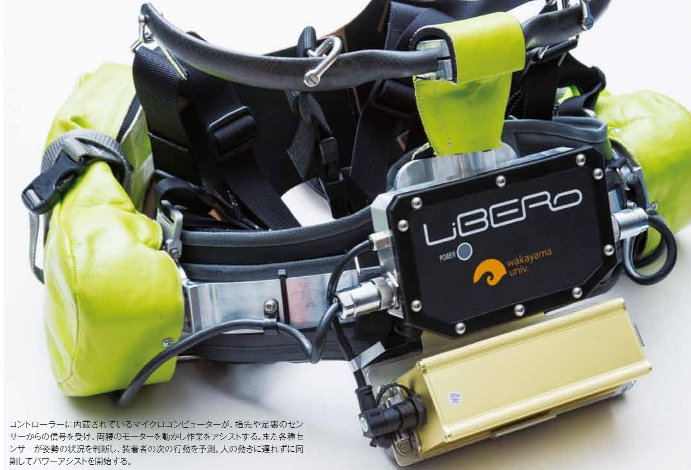
コントローラーに内蔵されているマイクロコンピューターが、指先や足裏のセンサーからの信号を受け、両腰のモーターを駆動し作業をアシストする。また各種センサーが姿勢の状況を判断し、装着者の次の行動を予測。人の動きに遅れずに同期してパワーアシストを開始する。
