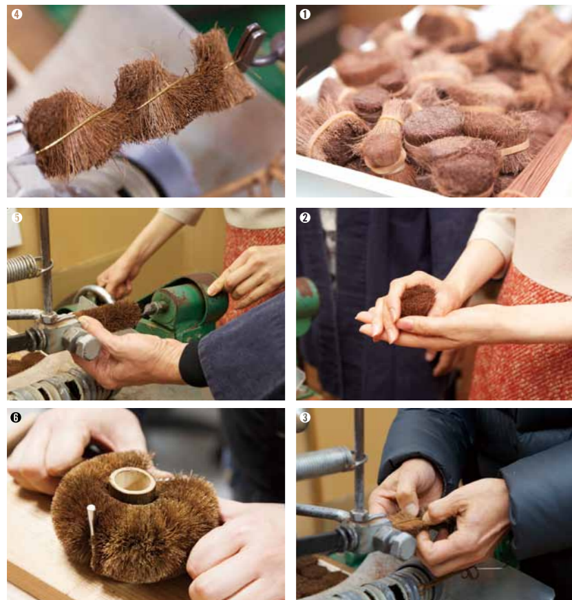
①毛捌き機にかけられ、水洗いし柔らかさや色味によって分類され均等な長さに切り揃えられた棕櫚。②巻き上げ機にセットする前の束ねられた棕櫚。③巻き上げ機にセットされた針金の間に繊維を挟んでいく。美しい仕上がりのためにムラ無く並べる。④ハンドルを絶妙な力加減で巻き上げていく。強く巻けば繊維を切ってしまうし、緩ければ抜け落ちる。⑤巻き終えたら手で触って確認する。⑥最後に丸めて見慣れた形の束子となる。
