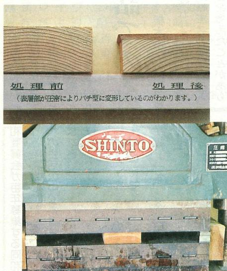
曲げ木といって、木材に水と熱を加え、やわらかくし、一定の形に固定し乾燥させる方法があります。これを応用し、水に溶かした特殊な接着剤をスギ材に注入し、マイクロ波照射装置(簡単に言えば、家庭用電子レンジの大型)で加熱するとふやけて、やわらかくなります。そして、熱圧成形機(写真下)を使って圧縮すると、表面が硬く、傷
